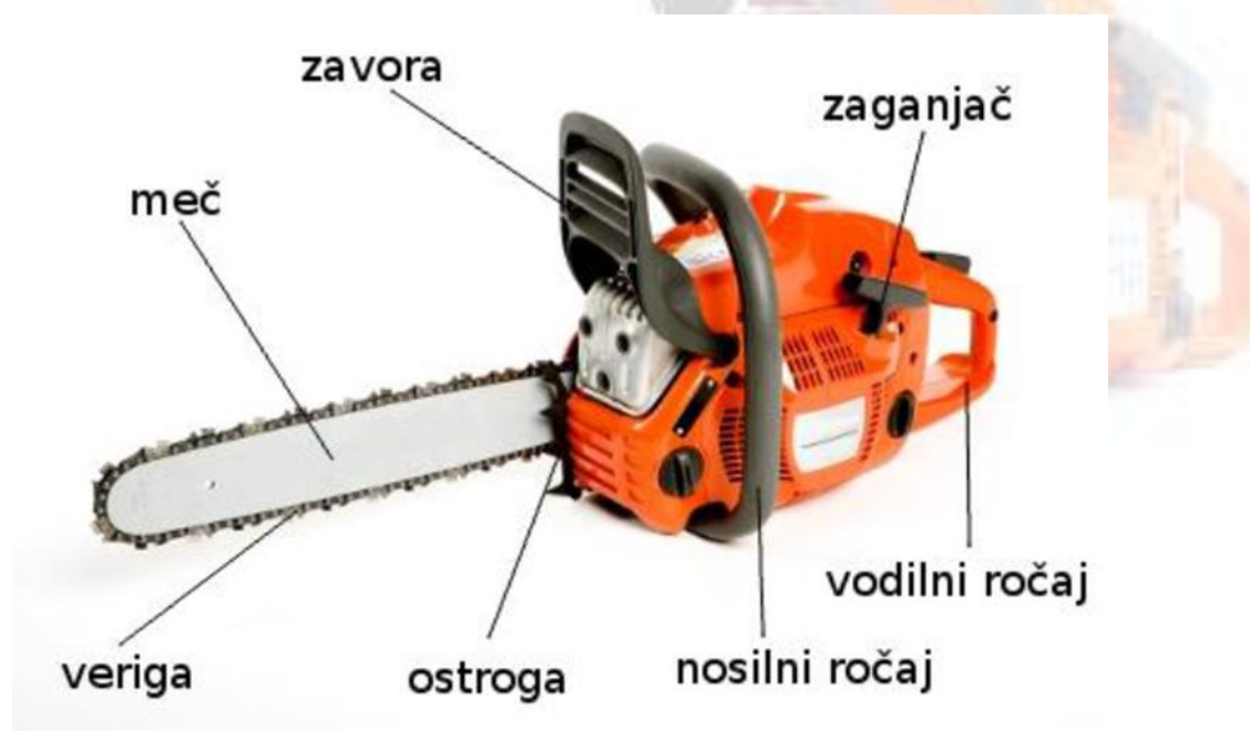
Slika 9. Motorna verižna žaga je osnovno orodje vsakega sekača. Z njo podira, klešči in prežaguje drevje.
